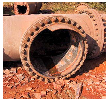
Resultat efter afrensning med en tankrenser
